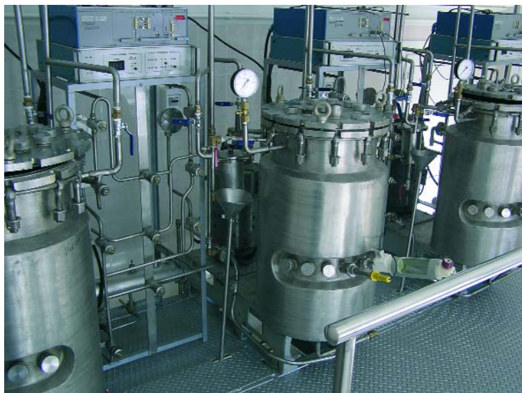
Установка мікробного синтезу лізину Інституту харчової біотехнології та геноміки НАН України
