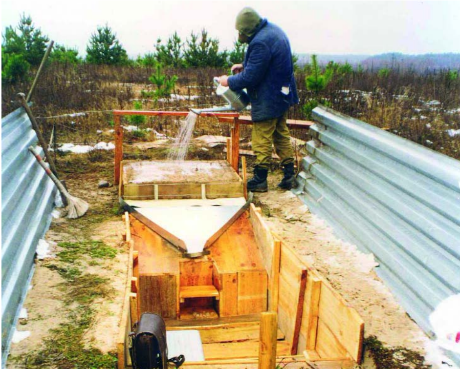
Проведення експерименту на малому стоковому майданчику з визначення змивання радіонуклідів із поверхні ґрунту
