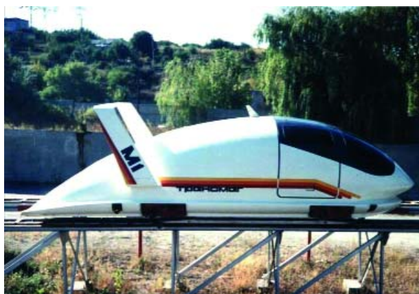
Рис. 5. Діюча модель екіпажу високошвидкісного наземного транспорту з електродинамічним підвісом на надпрвідних магнітах
