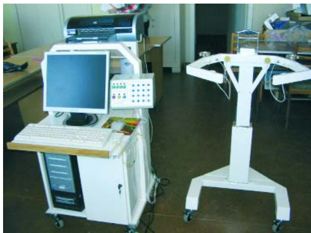
Рис. 4. На основі фундаментальних досліджень генерації та розповсюдження звуку в складних неоднорідних середовищах розроблено, створено та сертифіковано екологічно безпечний “Фоноспірографічний комп’ютерний комплекс KoPA-03M1”, призначений для діагностики і моніторингу бронхолегеневих захворювань людини
