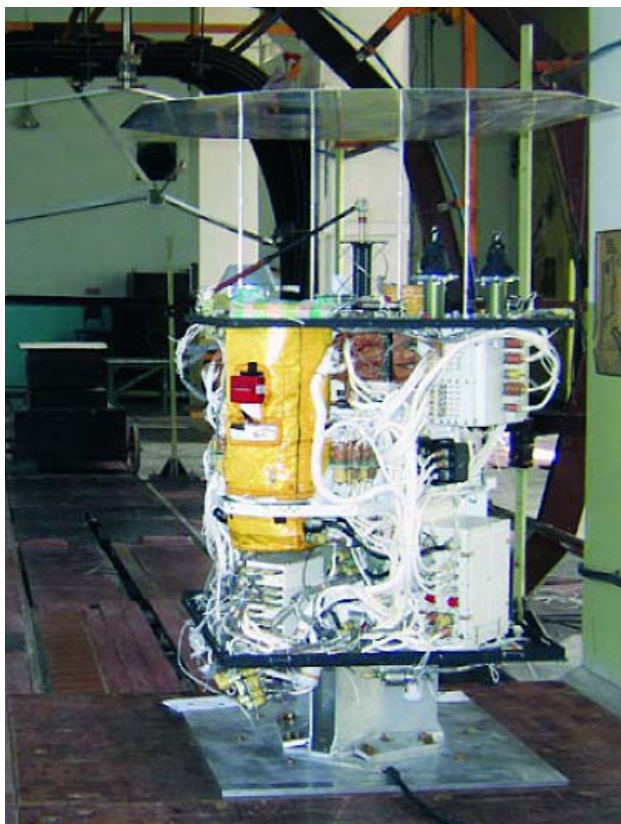
Рис. 10. Визначення магнітних параметрів космічного апарата “EgiptSat-1” на Магнітодинамічному комплексі НТЦ МТО НАН України
