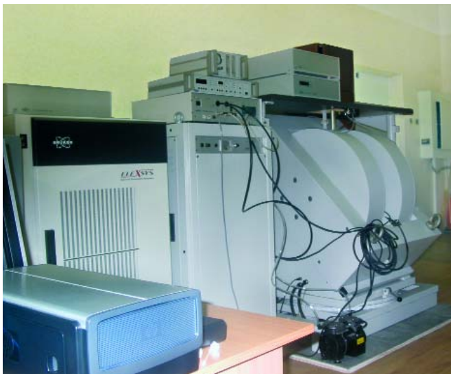
Спектрометр ELEXIS E500 для дослідження електронного парамагнітного резонансу в магнітних речовинах
