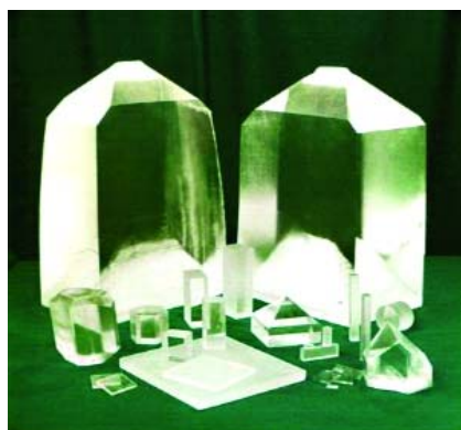
Нелінійно-оптичні монокристали груп KDP и DKDP
