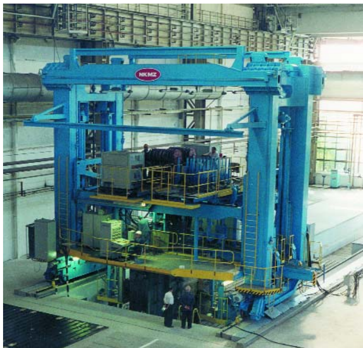
Установка для електрошлакового зварювання металу великої товщини (до 4 м)
