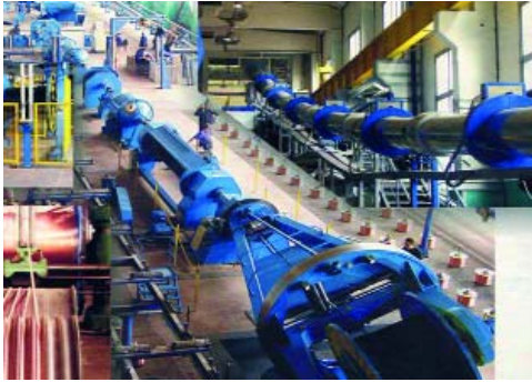
Лінія виготовлення кабелів з полімерною ізоляцією на напруги до 110 кВт на заводі "Південкабель"
