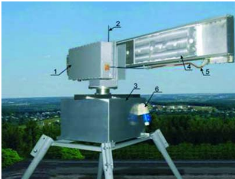
Радіолокаційна система міліметрового діапазону нового типу для спостереження за об'єктами і їхнім рухом на територіях аеропортів
