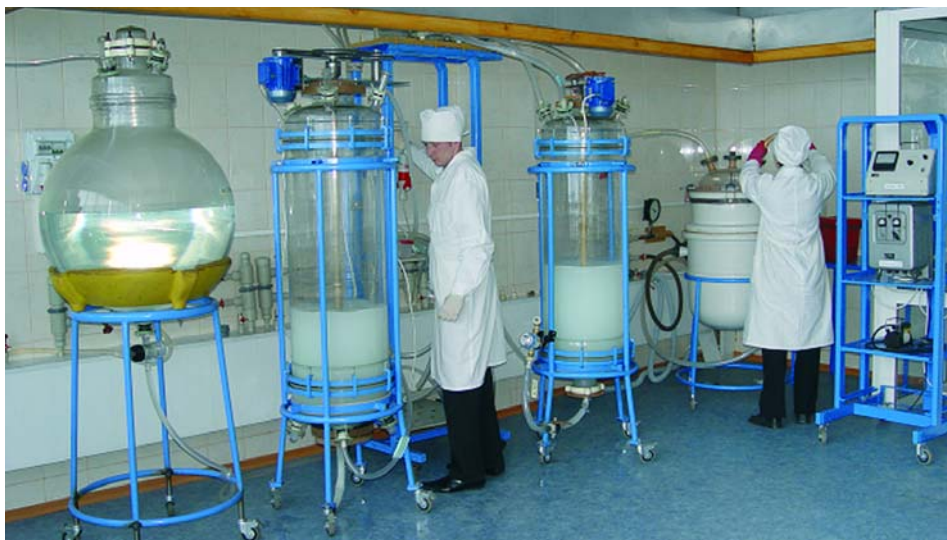
Первая в Украине пилотная линия для получения оксидных нанопорошков. Донецкий физико-технический институт им. А.А. Галкина НАН Украины
