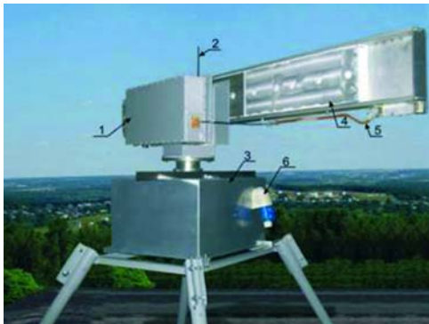
Радиолокационная система миллиметрового диапазона нового типа для наблюдения за объектами и их движением на территориях аэропортов
