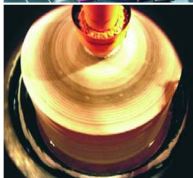
Выращивание монокристалла \text{NaI(Tl)} (550 кг)
