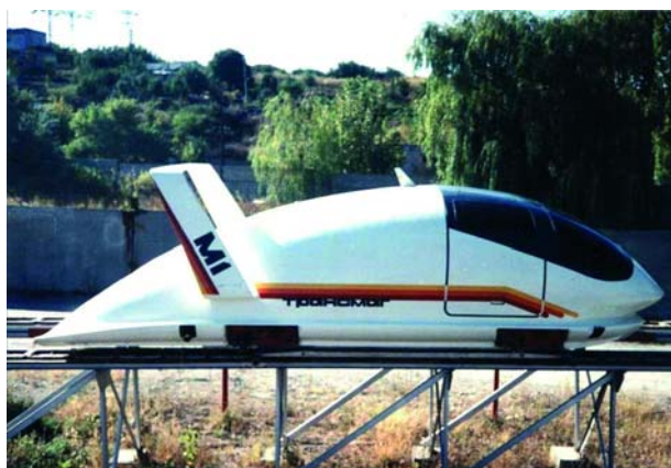
Рис. 5. Действующая модель экипажа высокоскоростного наземного транспорта с электродинамическим подвесом на сверхпроводящих магнитах
