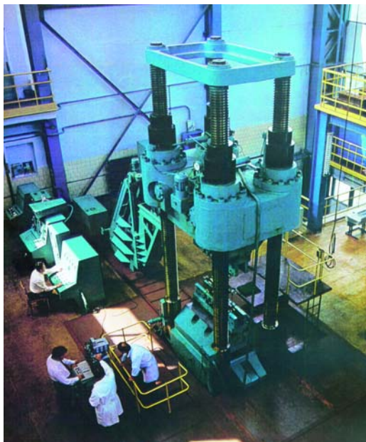
В лаборатории прочности сварных конструкций. Испытания на усталость
