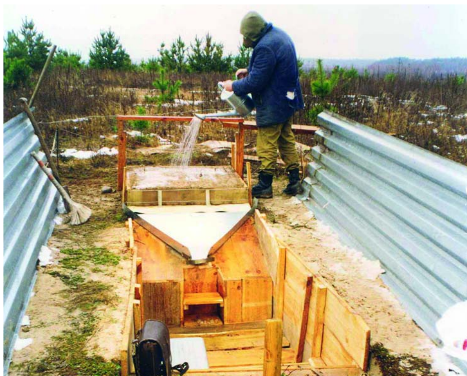
Проведение эксперимента на малой стоковой площадке по определению смыва радионуклидов с поверхности грунта
