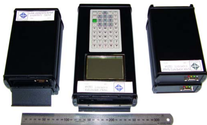
Рис. 15. Внешний вид пульта оператора и четырех блоков 24-канальной шахтовой сейсмостанции
