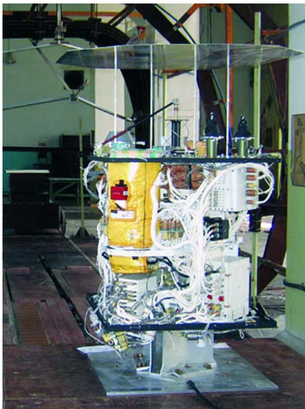
Рис. 10. Определение магнитных параметров космического аппарата "EgiptSat-1" на Магнитодинамическом комплексе НТЦ МТО НАН Украины
