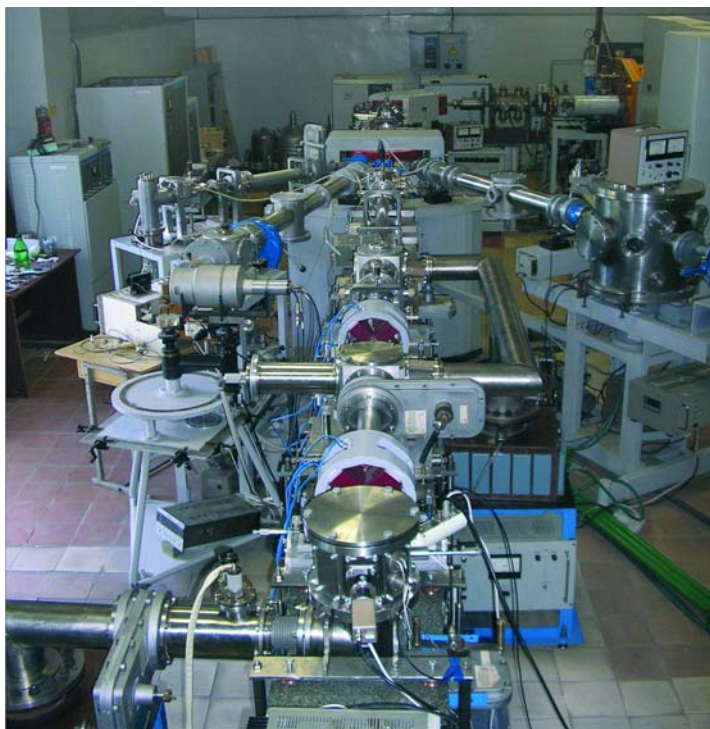
Рис. 4. Ядерный сканирующий микронзонд на основе электростатического ускорителя
