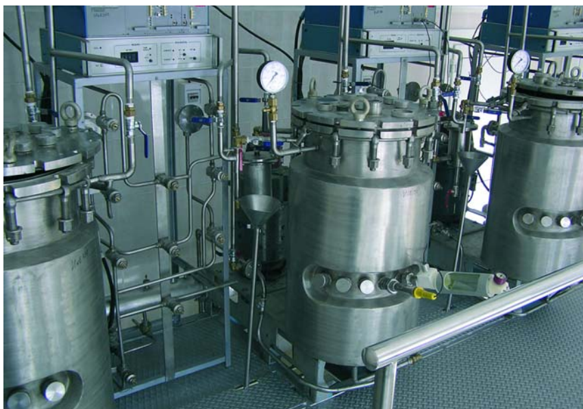
Установка микробного синтеза лизина Института пищевой биотехнологии и геномики НАН Украины
