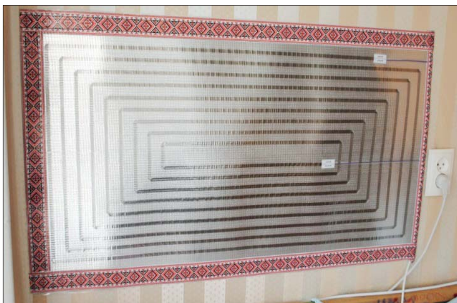
29. Низькотемпературний плівковий нагрівач на основі аморфної нанокристалічної металеві стрічки – розробка науковців Інституту металофізики ім. Г. В. Курдюмова НАН України.
