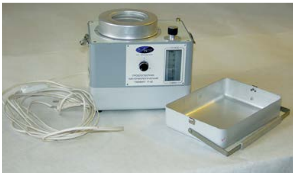
Фото 4. Переносний прилад для бактеріологічного аналізу повітря Тайфун (Р-40)
