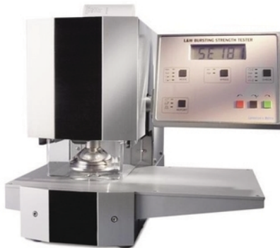
Фото 3. Прилад для вимірювання опору продавлюванню
