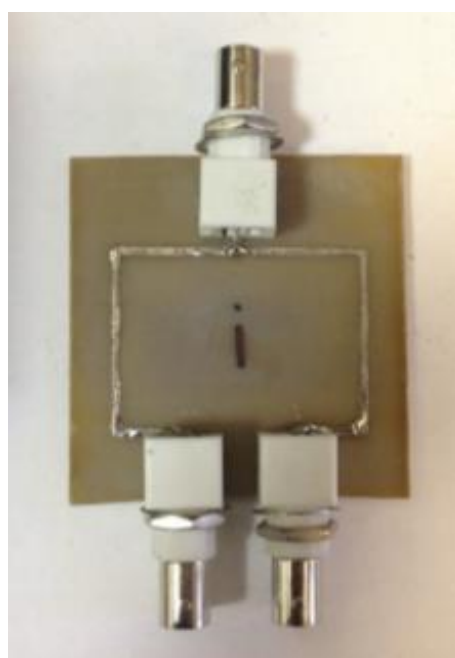
Рисунок 9 – Макет моноімпедансного логічного елемента «І»
