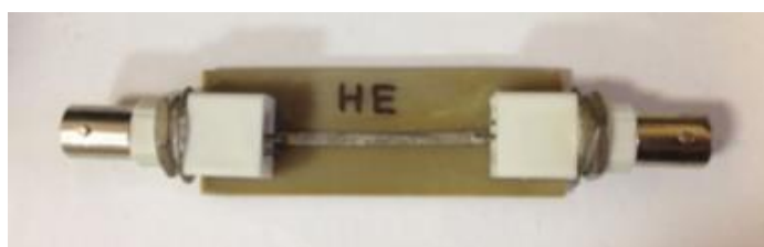
Рисунок 7 – Макет моноімпедансного логічного елемента «НЕ»
