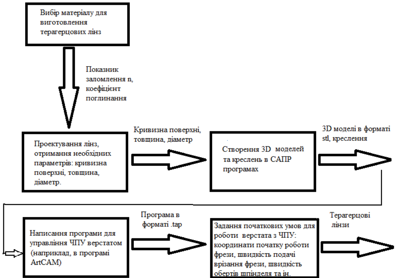
Рис. 5. Загальна структурна схема послідовності етапів для виготовлення поверхонь другого порядку терагерцових лінз. На рис. (6 - 8) представлені виготовлені ТГц лінзи і отримані функції розсіювання точки (ФРТ, PSF).
