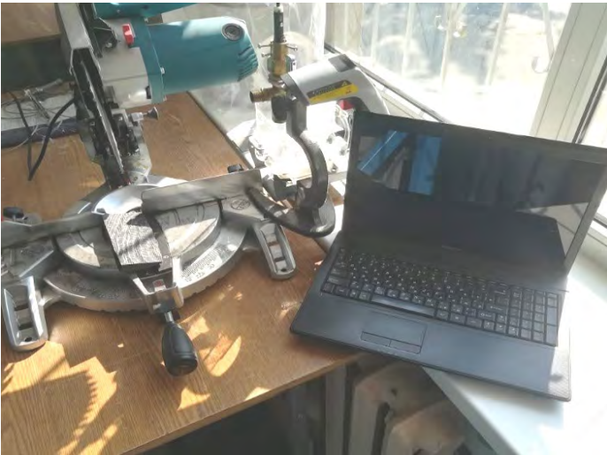
Рис. 8. Стенд для вимірювання температури матеріалу
