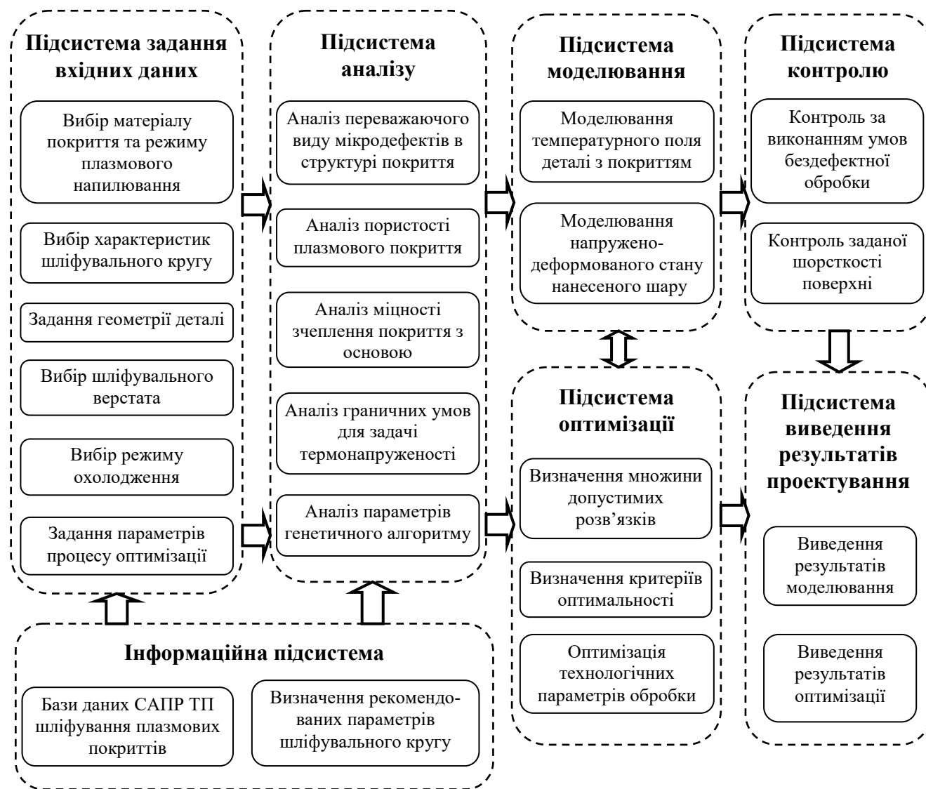
Рисунок 6 – Схема взаємозв'язків між модулями в розробленій САПР ТП шліфування плазмових покриттів
