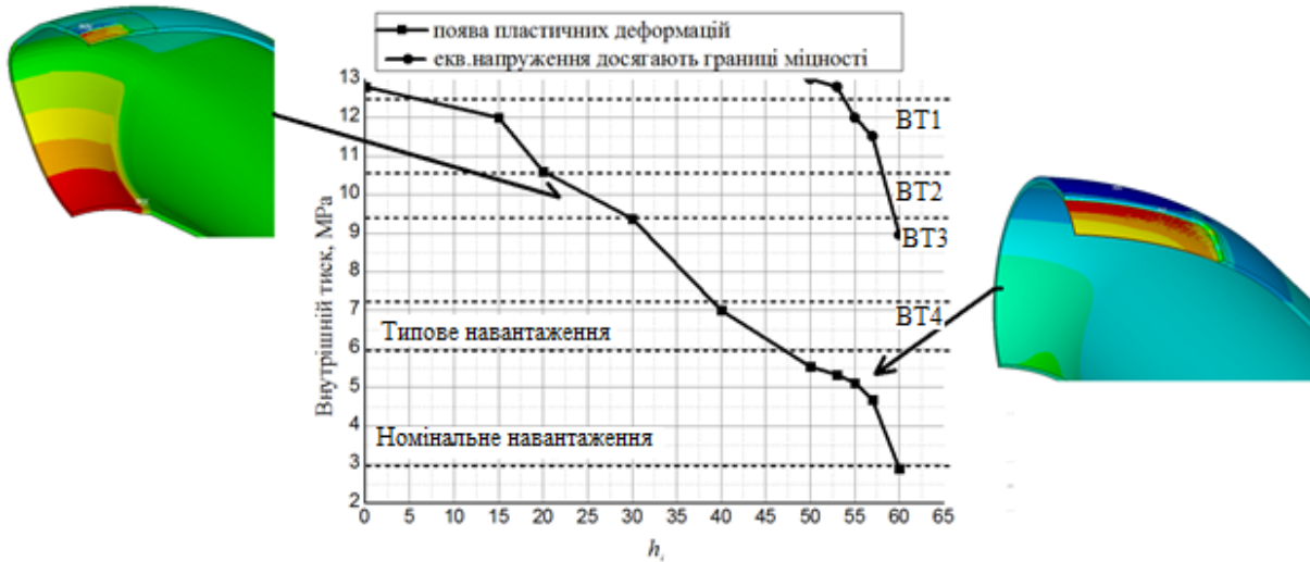
Рисунок 3 – Значення внутрішнього тиску, що призводить до появи пластичних деформацій в конструкції та досягання границі міцності
