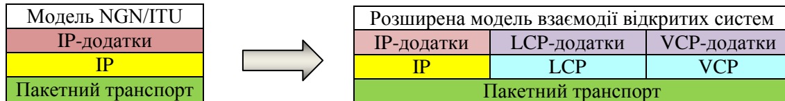
Рисунок 1 – Розширена трирівнева модель взаємодії відкритих систем
