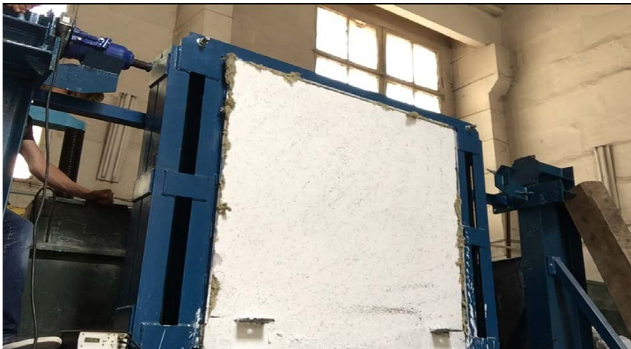
Рис.1. Стенд для випробування стінових панелей
