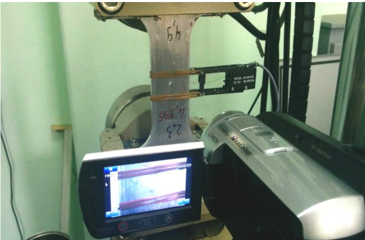
Рис. 2. Процес проведення експерименту та фіксації відповідних експериментальних даних при циклічному навантаженні зразка з концентратором у вигляді отвору
