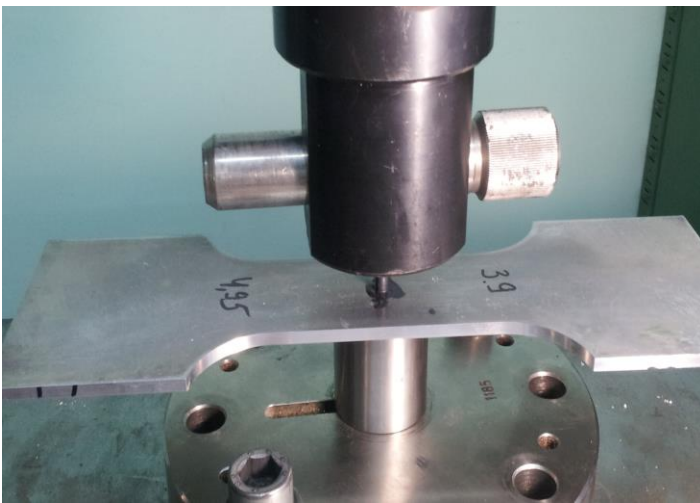
Рис. 1. Процес дорнування отворів на випробувальному стенді TIRAtest 2300
