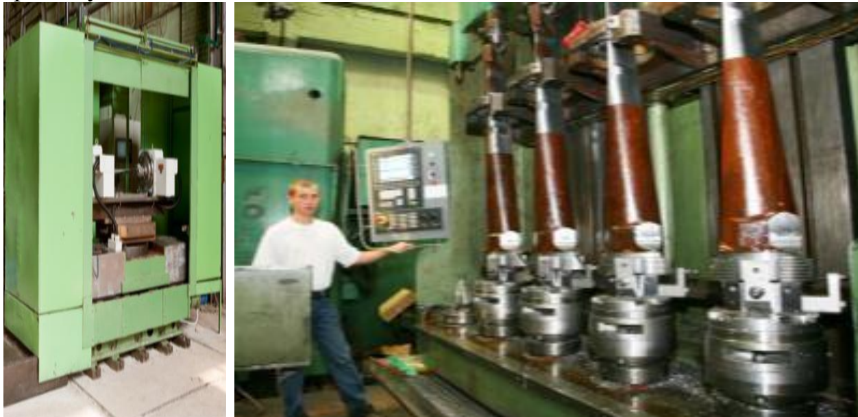
Рисунок 13 – Обробка турбінних лопаток на модернізованих верстатах моделі ІС-800ПМФ4 и фірми «Форест»
