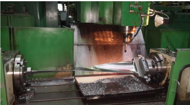
Фрезерування галтелів у хвоста і бандажа
