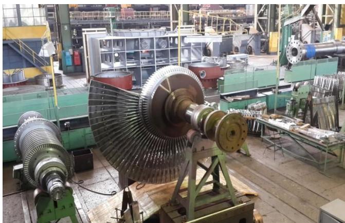
Рисунок 6 - Складання ряду на технологічному диску
