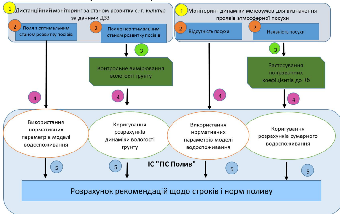
Рис. 11. Схема алгоритму уточнення планів поливів із використанням даних ДЗЗ та наземних спостережень у складі ІС «ГІС Полив»
