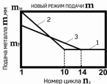
Рис. 8. Режими 1, 2 і 3 подачі m при затравці гільзи з підготовленим переднім кінцем
