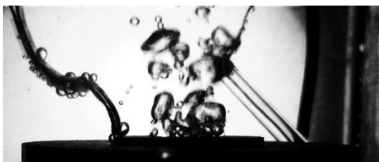
Рис. 4. Візуалізація процесу кипіння на гладкій поверхні у великому об'ємі (а) та при висоті вільного простору 7,5 мм (б) ( q=80 \text{ кВт/м}^2 )
