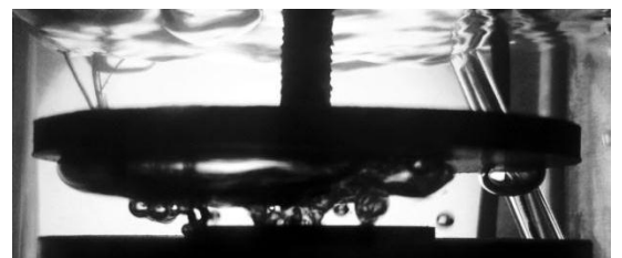
Рис. 4. Візуалізація процесу кипіння на гладкій поверхні у великому об'ємі (а) та при висоті вільного простору 7,5 мм (б) ( q=80 \text{ кВт/м}^2 )
