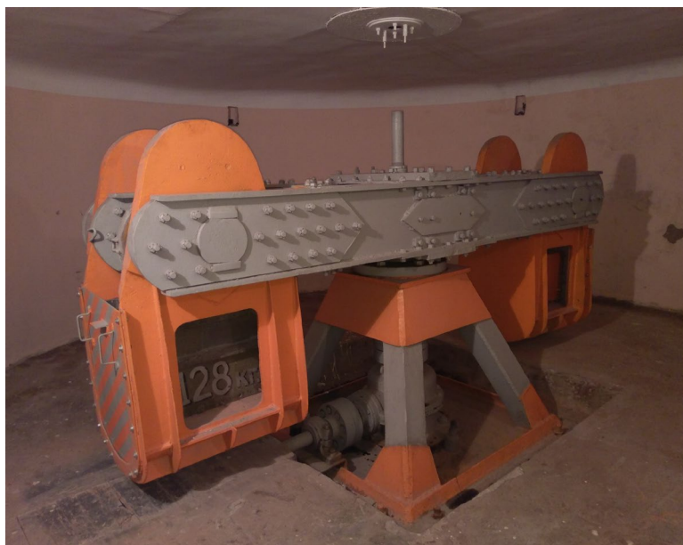
Рис. 1. Центрифуга, на якій проводились дослідження стійкості моделі схилу балки Довгий байрак (ДНУЗТ ім. академіка В. Лазаряна)
