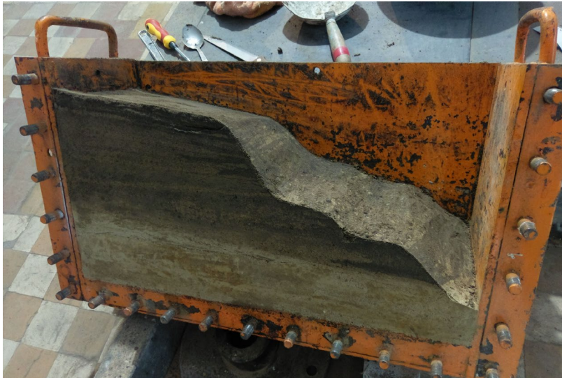
Рис. 2. Модель у масштабі 1:100 після підрізання зайвого ґрунту
