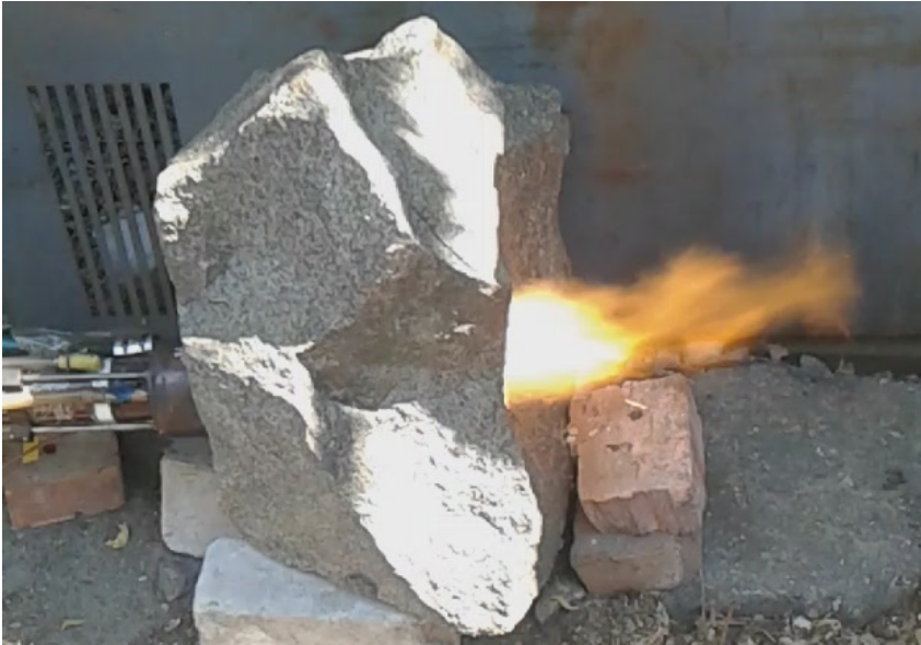
Рисунок 13 – Процес термічного розширення гірської породи за допомогою плазмової струмینی осевого плазмотрона
