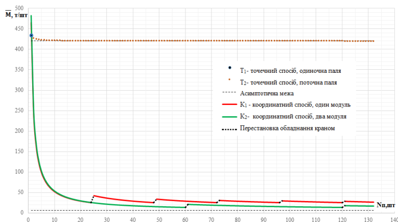
Рис. 7. Залежність \bar{M} від кількості паль (Nп) для варіантів T 1 , T 2 , K 1 і K 2 при різній кількості процесів перестановки системи на наступну (нову) захватку, монтажну ділянку
