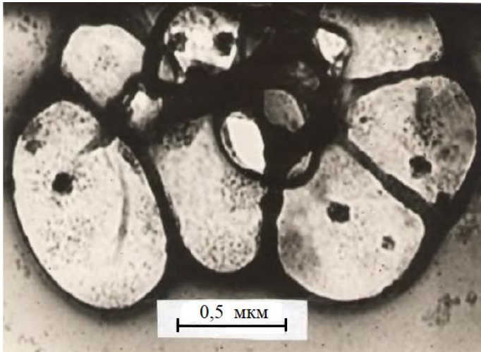
Рисунок 4 – Електронно-мікроскопічна фотографія непроявлених чистих МК AgBr фотошару з утвореними срібними нитками, під дією інфрачервоного лазерного світла при нормальному лазерному ефекті Гершеля з такими параметрами: перша експозиція білим світлом 0,5 с; довжина хвилі лазерного світла 850 нм; потужність в імпульсі лазерного світла 4 Вт; тривалість імпульсу 2 \cdot 10^{-7} с; частота слідування імпульсів 16 кГц; та поверхнева густина енергії \geq 546 \text{ Дж/см}^2 .
