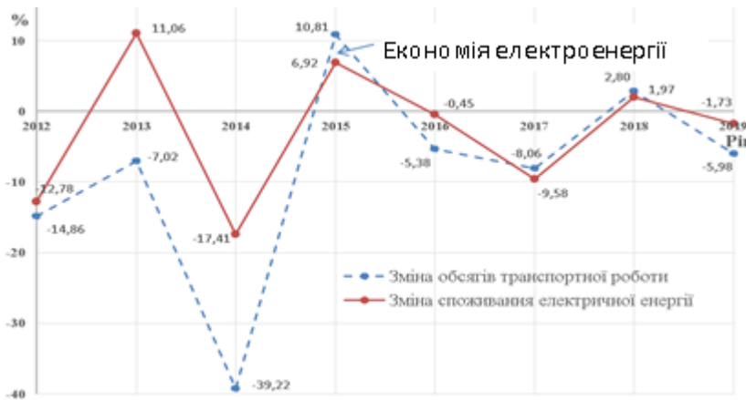
Рисунок 4 – Динаміка зміни загального обсягу перевезень (тис. пас·км) і споживання енергоресурсів (тис. кВт·год), у % до попереднього року
