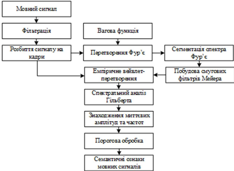
Рис. 5. Метод семантичного кодування мовних сигналів на основі емпіричного вейвлет-перетворення та спектрального аналізу Гільберта
