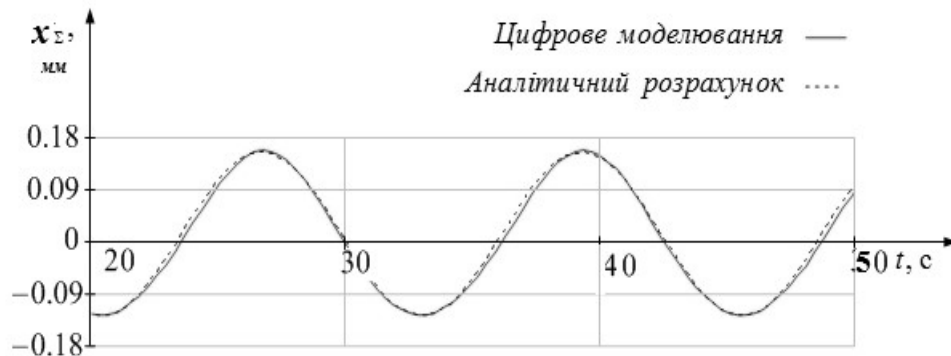
Рис. 5. Порівняння отриманих результатів вихідного сигналу (зміщення ІМ) при поступальних збуреннях із частотою \omega = \omega_0 цифрового моделювання із результатами аналітичних розрахунків
