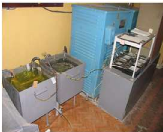
Рис. 7 - Загальний вид установки для плазмоелектролітного оксидування
