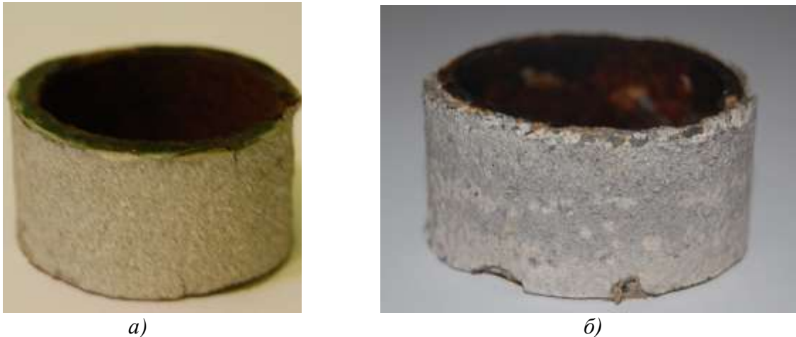
Рис. 28 – ППМ з порошку сталі ШХ15 після нанесення електрометалізаційного (а) та ПЕО покриття (б)
