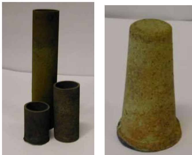
Рис. 27 – Загальний вигляд ППМ на основі карбіду титану та ШХ15
