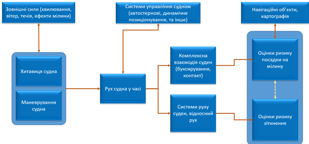
Рисунок 6 - Схема моделювання руху судна при рішенні навігаційних задач
