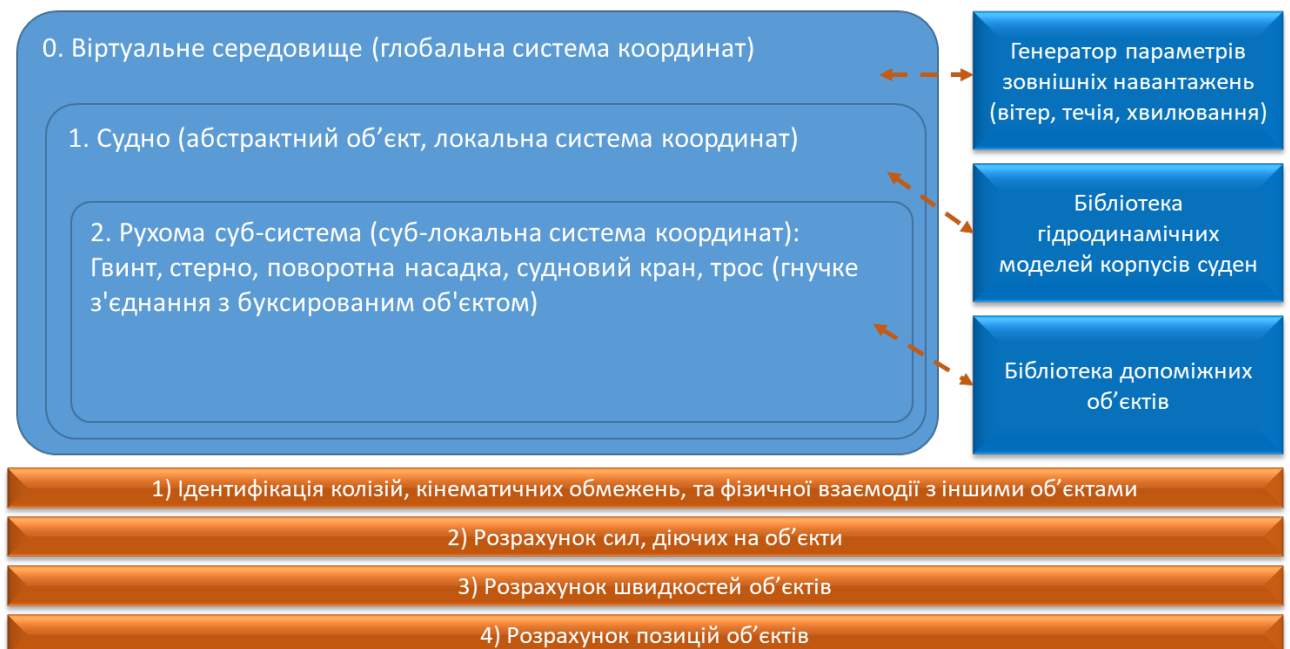
Рисунок 9 - Схема програмної реалізації групи суден в середовищі симулятора методами об'єктно орієнтованого програмування
