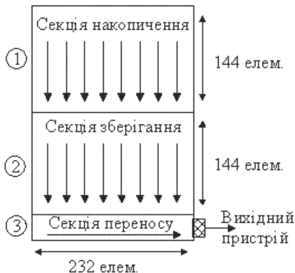
Рисунок 3.22 – Принцип побудови ПЗЗ-перетворювача з покадровим перенесенням
