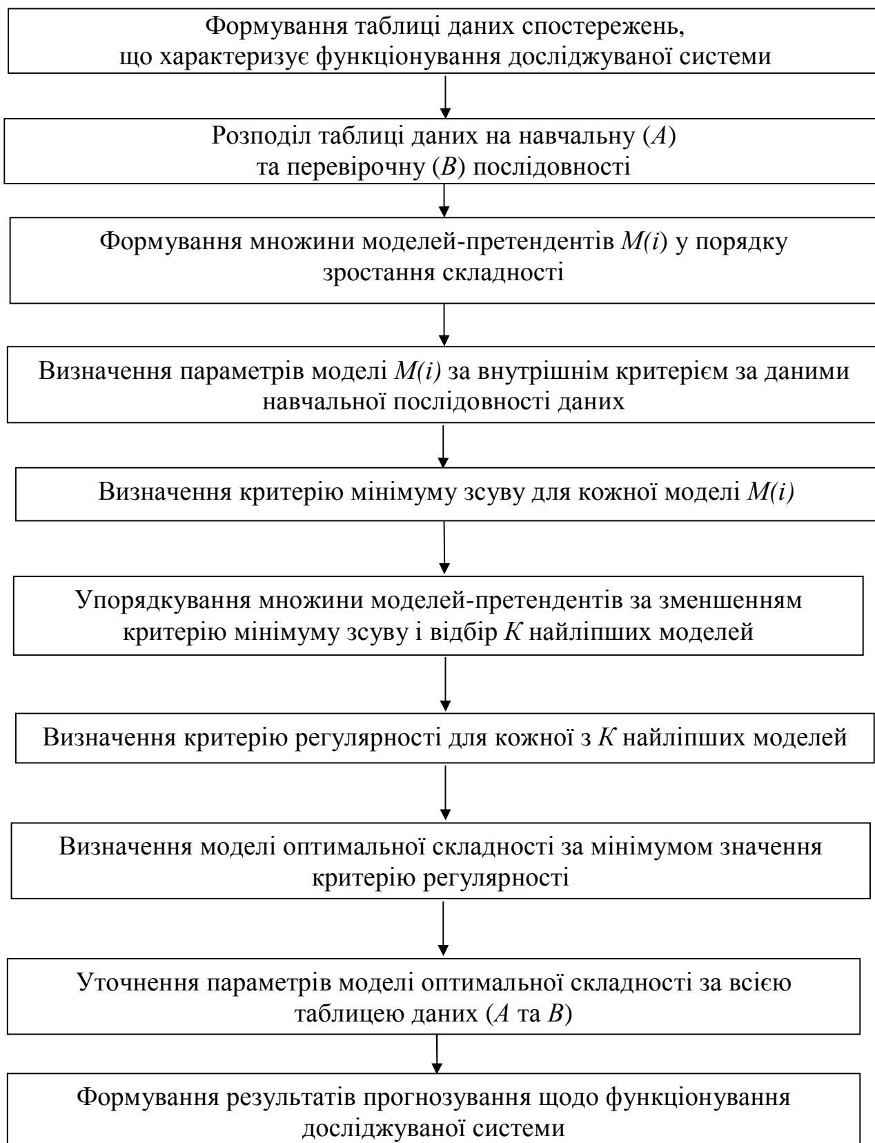
Рисунок 9.6. Узагальнена схема однорядного алгоритму самоорганізації моделей з послідовним використанням зовнішніх критеріїв
