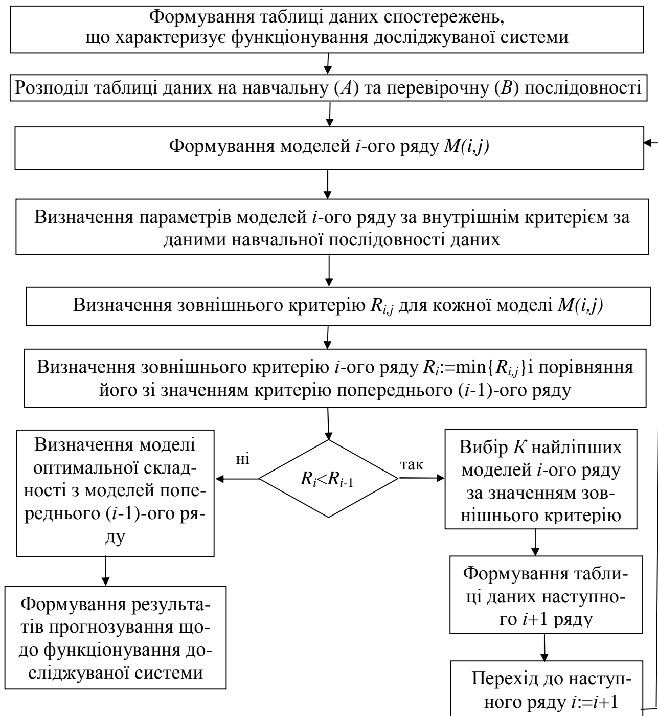
Рис. 9.15. Узагальнена схема багаторядного алгоритму самоорганізації моделей
