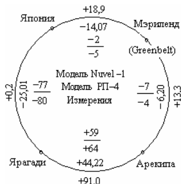
Рис. п2. 9. Квазиокружность «Ярагади» с недопустимо разбалансированными дугами в модели Nuvel-1
