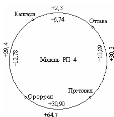
Рис. п2. 5. Большая квазиокружность Калгари-Оттава-Претория-Ороррал с хорошим балансом составляющих дуг
