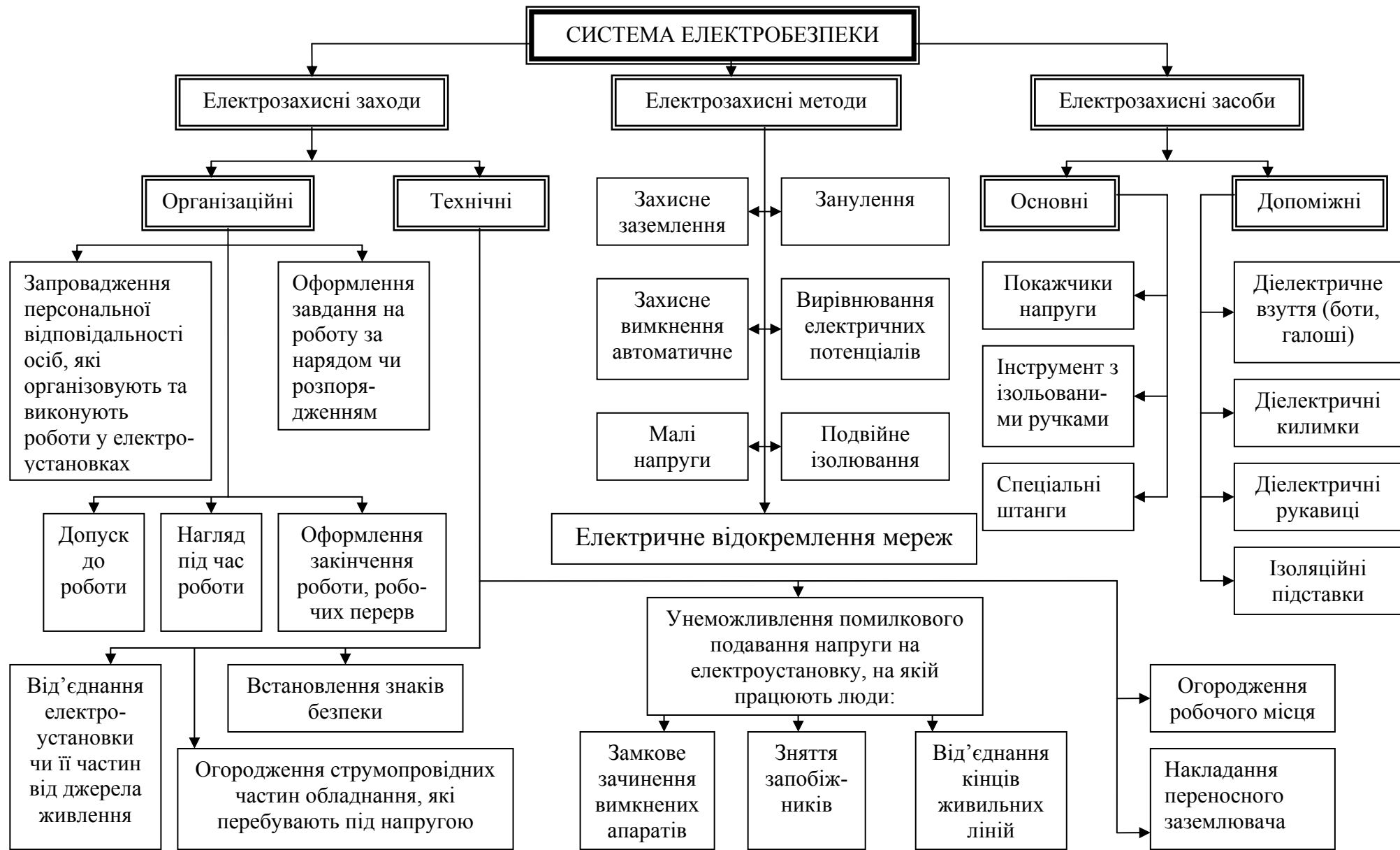
Рис. 4.5. Блок-схема системи електробезпеки
