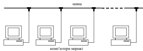
Рис. 1. Комп'ютерна мережа шинної топології
