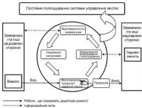
Модель СУЯ, що базується на процесному підході
