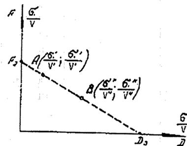
Рис. 2.6. Системы обнаружения с разными значениями параметров  $\sigma_1/V$  и  $\sigma_0/V$ , которые могут обеспечить одинаковые пары F и D
