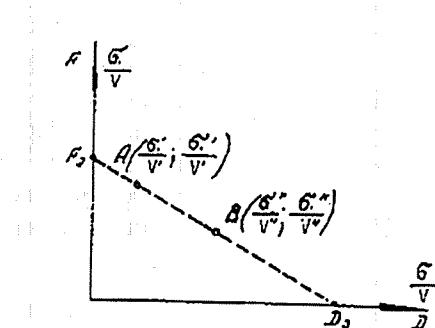
Рис. 2.6. Системы обнаружения с разными значениями параметров  $\sigma_1/V$  и  $\sigma_0/V$ , которые могут обеспечить одинаковые пары F и D
