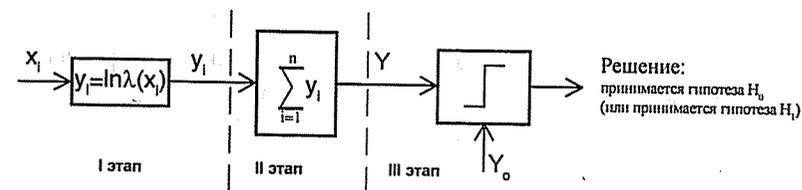
Рис. 1.1. Структурно-логическая схема правила принятия решения при проверке простых статистических гипотез  $H_0$  и  $H_1$
