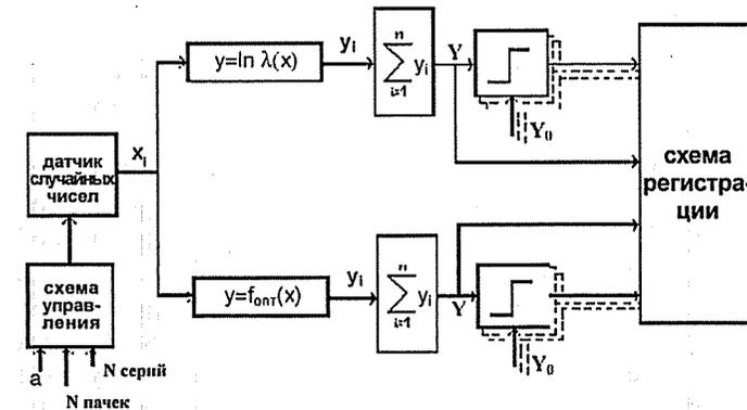
Рис. 5.1. Упрощенная схема реализации вычислительного эксперимента для сравнения эффективности двух критериев проверки простой статистической гипотезы против простой альтернативы
