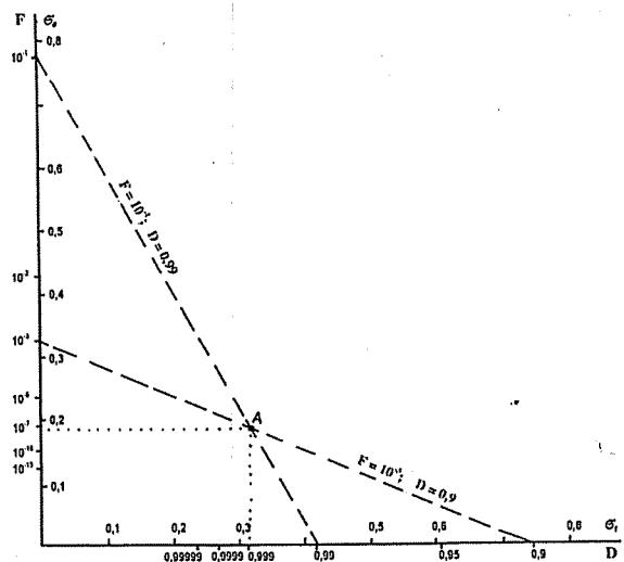
Рис. 2.3. Номограмма для определения количественных соотношений между вероятностью ложной тревоги  $F$  и вероятностью правильного обнаружения сигнала  $D$
