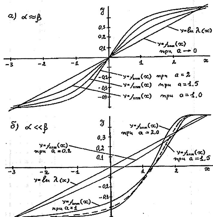
Рис. 4.1. Логарифмы отношений правдоподобия ( $\ln\lambda(x)$ ) и значения функции  $y = f_{opt}(x)$  при проверке гипотез о среднем значении гауссовой случайной величины при условиях: а)  $\alpha \approx \beta$ ; б)  $\alpha \ll \beta$ .
