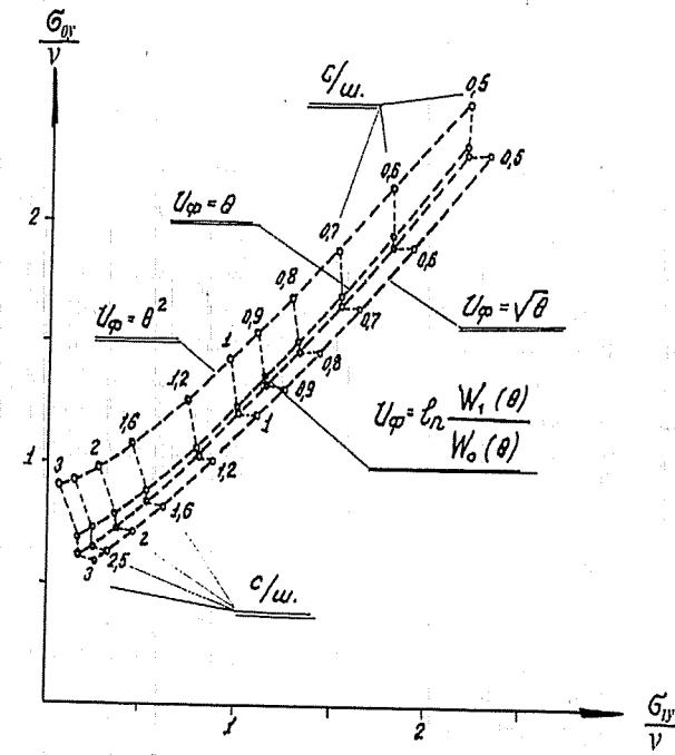
Рис. 2.11. Результаты расчета параметров  $\sigma_{0y}/v$  и  $\sigma_{1y}/v$  при некоторых отношениях сигнал/шум (с/ш) для системы обнаружения сигналов по распределению фаз.
