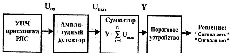
Рис. 2.9. Фрагмент упрощенной функциональной схемы приемника радиолокационной станции
