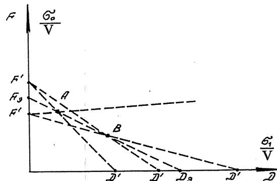
Рис. 2.7. Относительная эффективность двух систем обнаружения для разных требуемых пар  $F$  и  $D$
