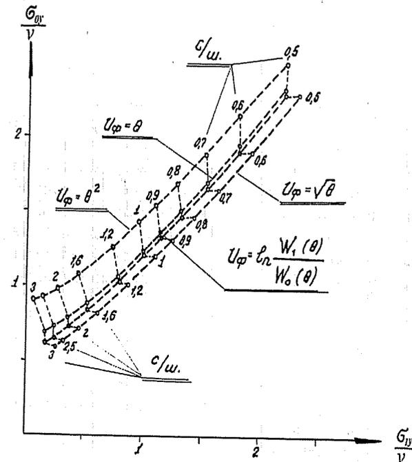
Рис. 2.11. Результаты расчета параметров  $\sigma_{oy}/v$  и  $\sigma_{iy}/v$  при некоторых отношениях сигнал/шум (с/ш) для системы обнаружения сигналов по распределению фаз.
