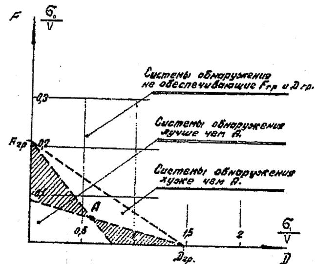
Рис. 2.8. Сравнение эффективности систем обнаружения при отображении их на номограмме
