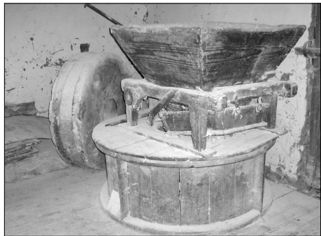
Верхній камінь з бункером для зерна
