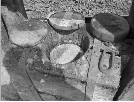
Камера і кружки, якими користувалися при витисканні олії
