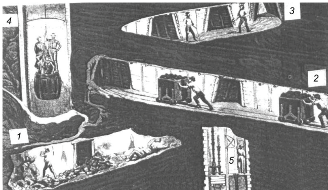
Рис. 3.5. Разрез рудника и этапы горных работ (середина XIX века):
