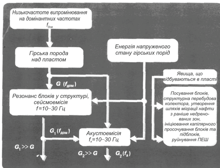
Рис. 3.3. Структура енергоперетворення в гірських породах на рівні пласта при ВСВ із земної поверхні [76]
