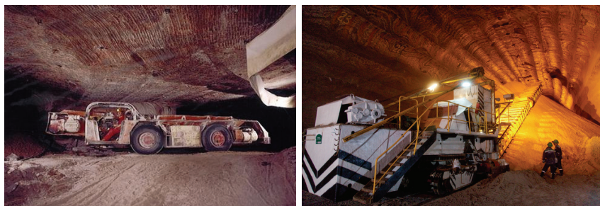
Рис. 4.12. Транспортировка калийной руды самоходными вагонами с добычной камеры (а) на подземный аккумулирующий склад (б)
