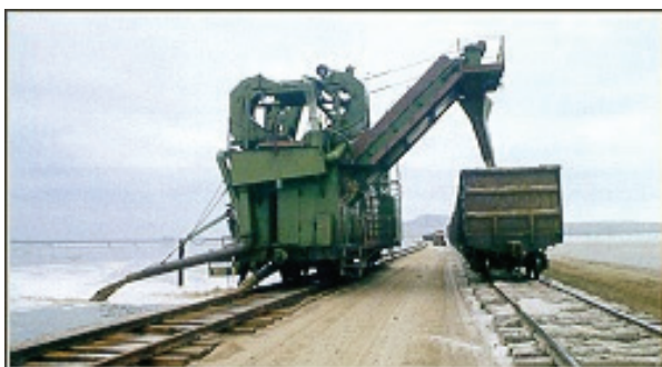
Рис. 3.3. Добыча соли солекомбайнами на озере Баскунчак
