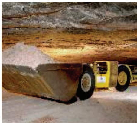
Рис. 4.14. Погрузка калийной руды в камере самоходным погрузчиком с емкостью ковша 20 т (рудник R+ S Kali GmbH, ФРГ)
