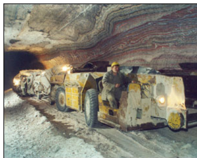
Рис. 4.11. Транспортировка руды самоходными вагонами
