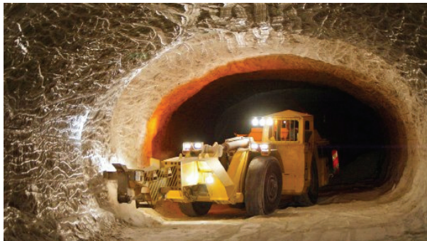
Рис. 6.2. Доставка отходов в подземные хранилища
