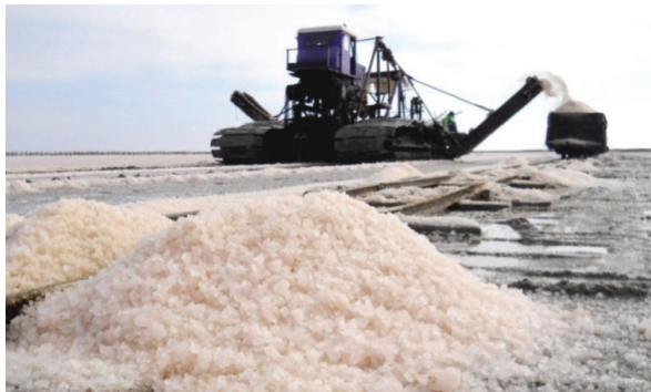
Рис. 3.6. Солекомбайн на гусеничном ходу
