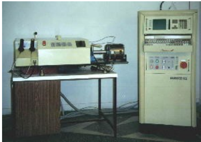
Рис. 1.5 Серія комп'ютеризованих стендів ELMOTE XX для діагностики електродвигунів
