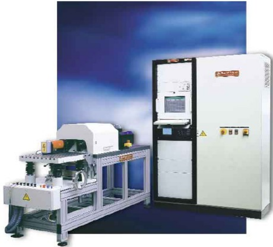
Рис. 1.4 Діагностичний стенд Штайгера Мохило електродвигунів для лабораторій і виробництва
