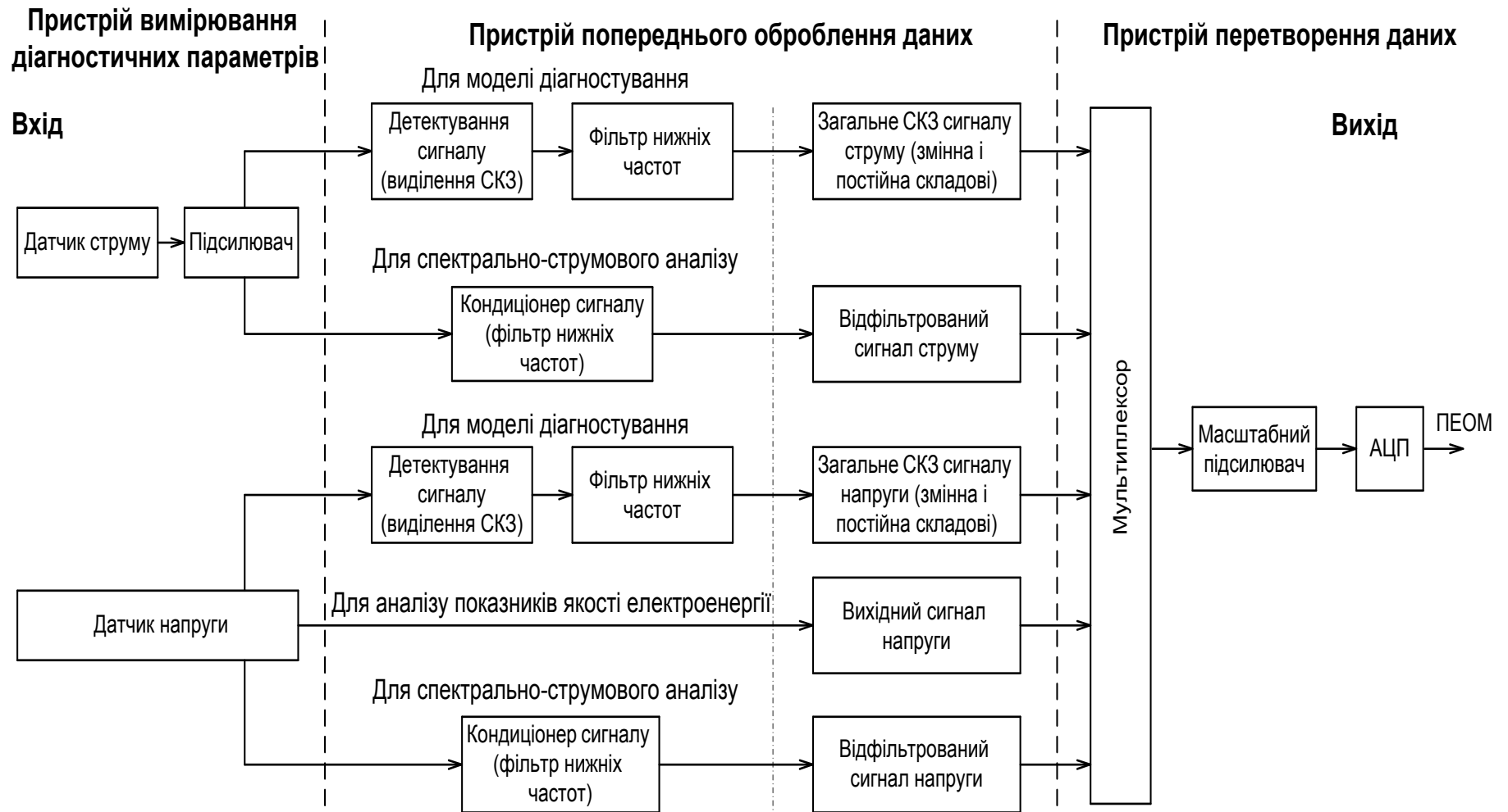
Рис. 4.2 Структурна схема пристроїв вимірювання, попереднього оброблення і перетворення діагностичних параметрів для однієї фази двигуна
