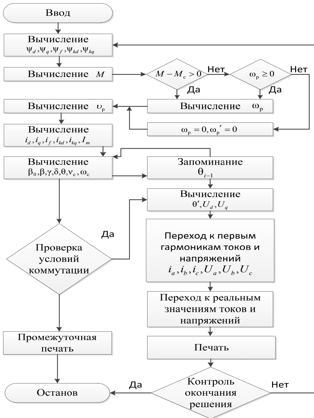
Рис. 2.8 Блок-схема цифровой модели ВД
