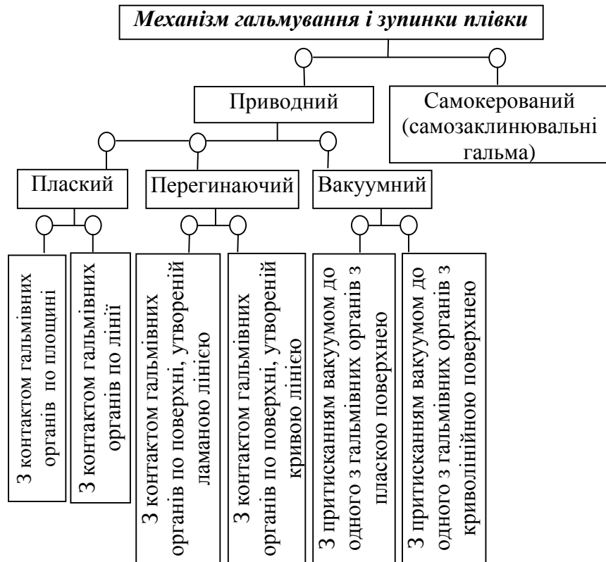
Рис. 2.53. Види механізмів гальмування і зупинки плівки
