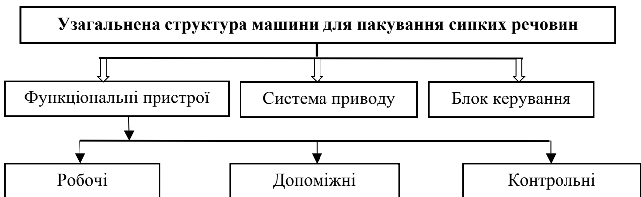
Рис. 2.3. Типова узагальнена структура машини для пакування сипких речовин
