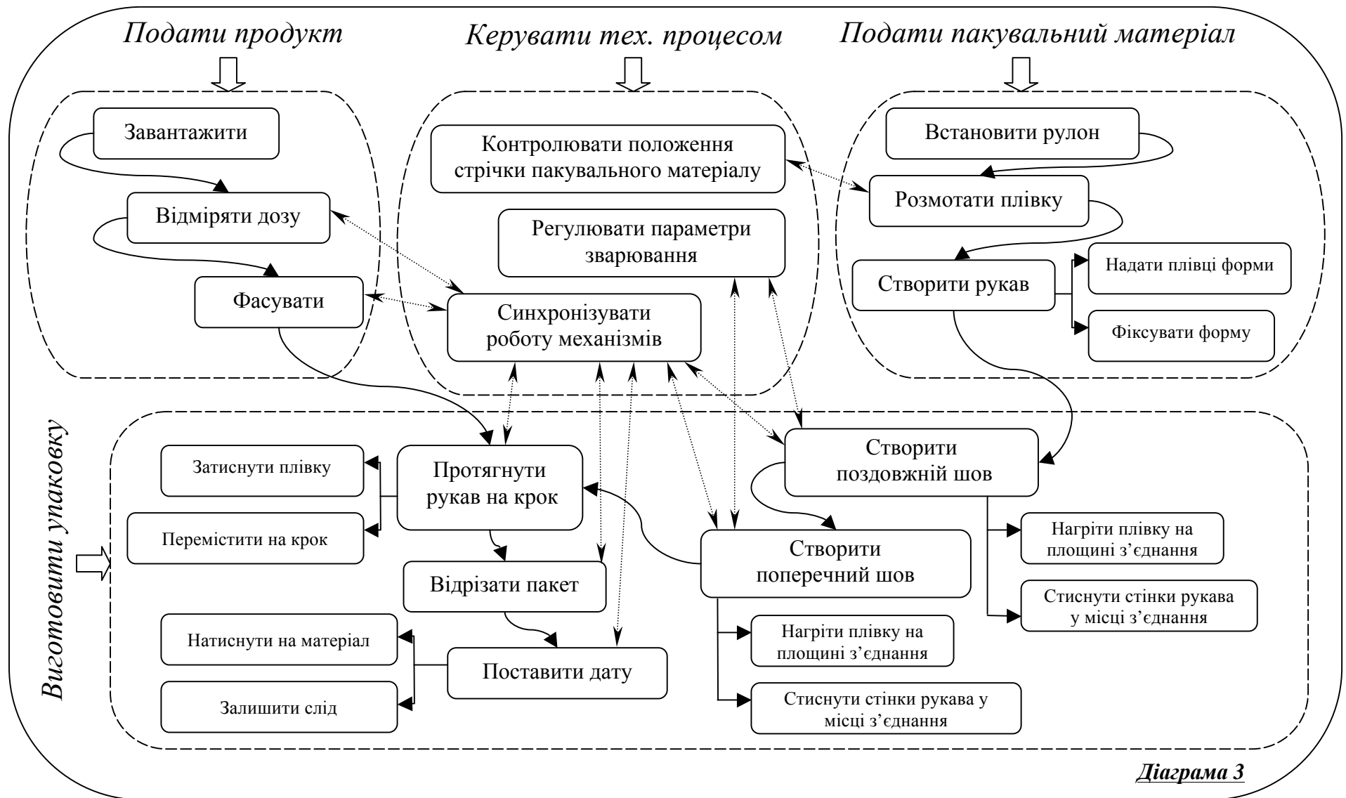
Рис. 3.12. SADT-модель технологічної операції пакування сипких речовин (діаграма 3)
