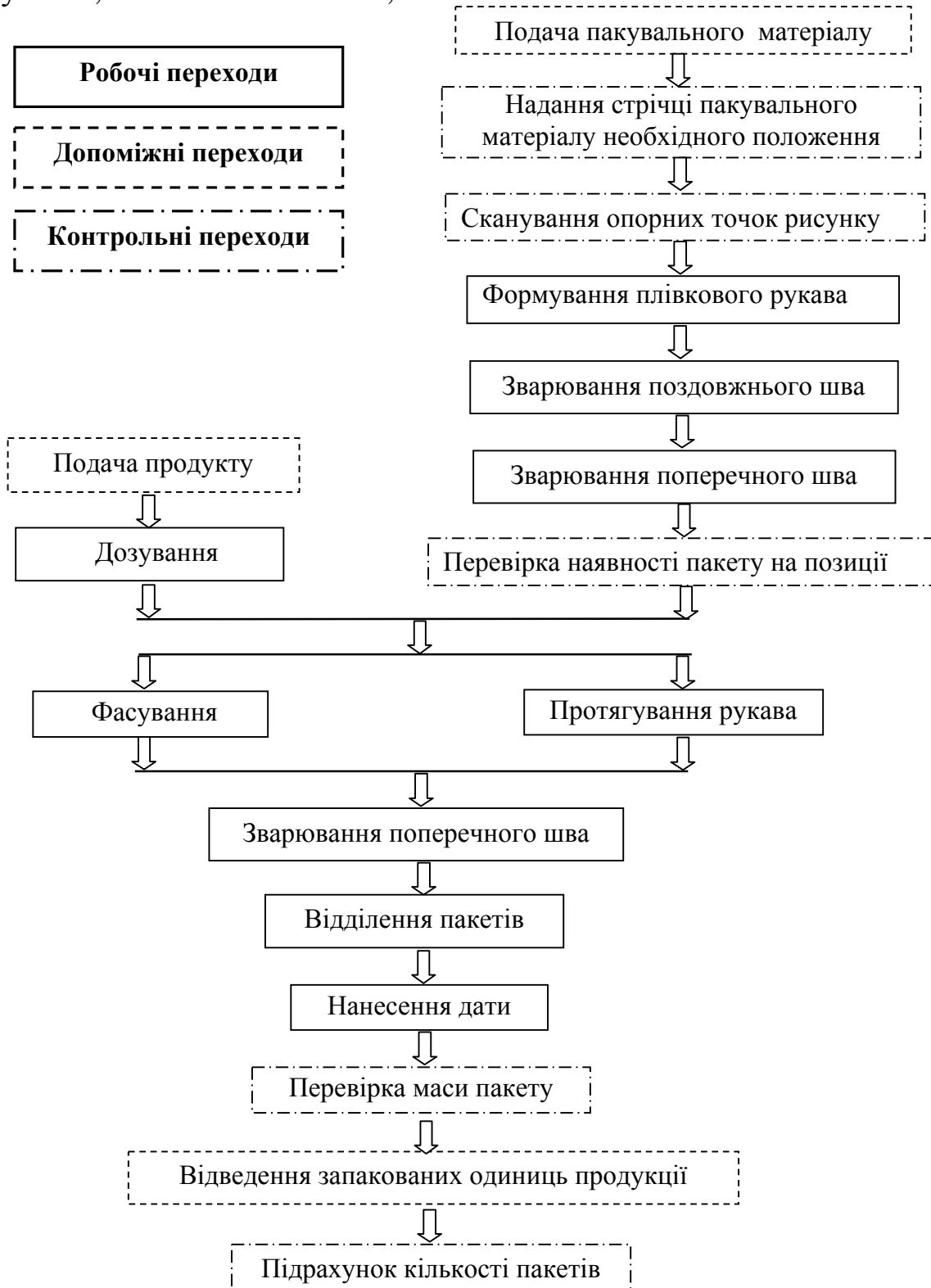
Рис. 2.2. Структура технологічної операції пакування сипких речовин
