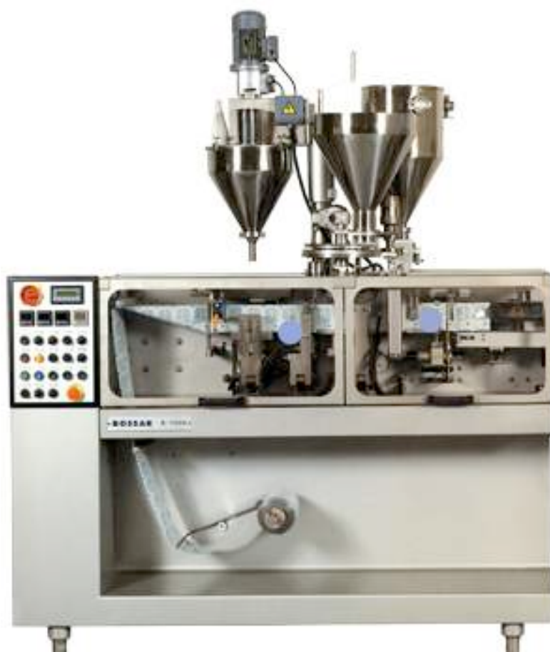
Рис. 2.25. Машини для пакування сипких речовин горизонтального типу
