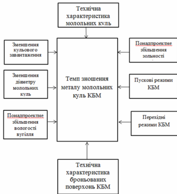
Рис.1. Блок-схема впливу різних факторів на темп зношення металу молотильних куль пилосистем з КБМ пилувугільних котлів енергоблоків ТЕС
