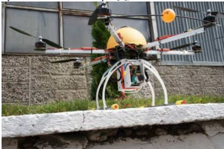
Рис. 1. Авторський прототип провідного дрону
