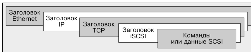
Рис. П.А.10. Инкапсуляция пакета SCSI в пакет IP
