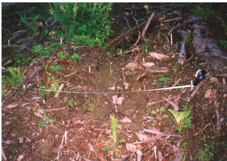
Рис. 1.4. Закладені репер-шпильки для моніторингу за розвитком ерозійних процесів на схилі північно-західної експозиції (вздовж річки Орява, с. Коростів)
