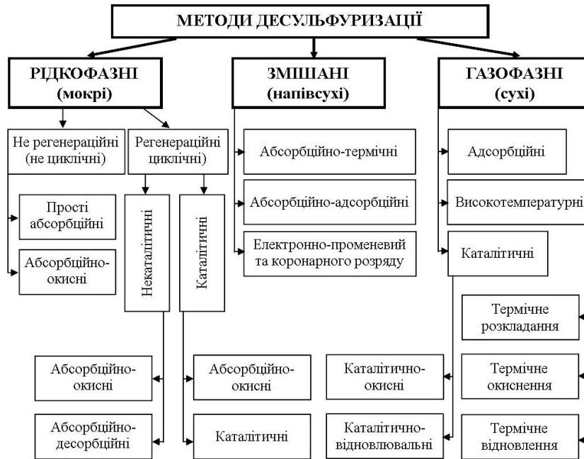
Рис. 6.13. Класифікаційна схема процесів десульфуризації димових газів
