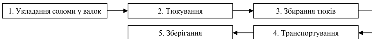
Рис. 4.34. Схема організації виробничого процесу по заготівлі тюкової соломи
