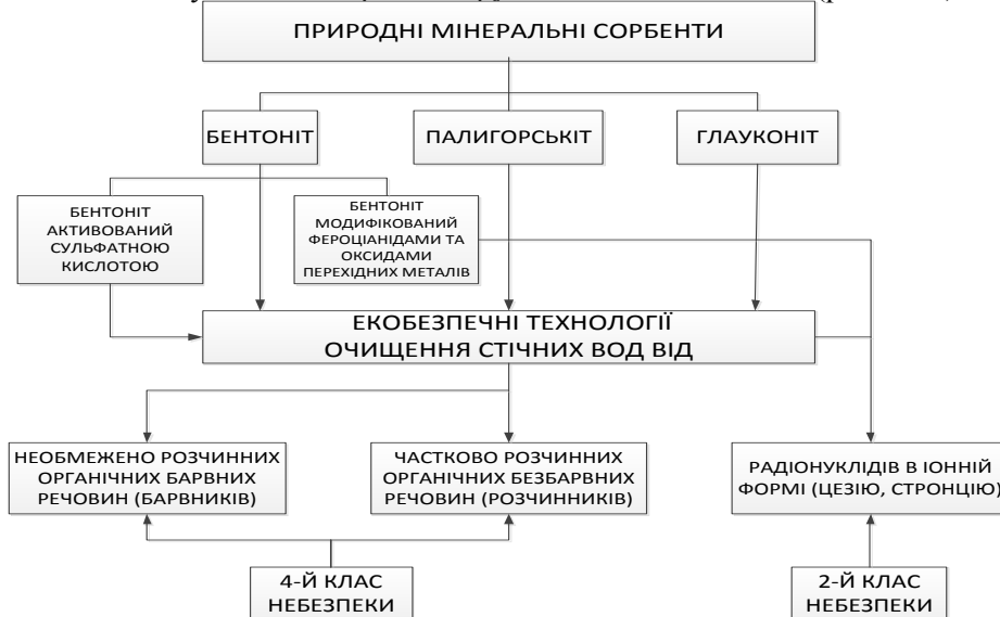
Рис. 6.31. Класифікація використання природних та модифікованих сорбентів в технологіях очищення стічних вод від забрудників 2 – 4-го класу небезпеки
