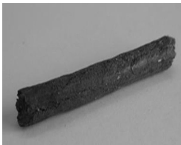
Рис. 5.44. Вид зразка пелет з опалого листа клену після екструзії
