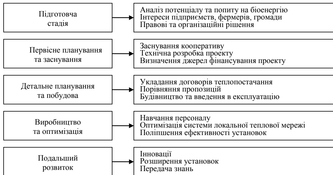
Рис. 2.23. Стадії реалізації проекту біоенергетичного селища на основі кооперативної взаємодії промислових підприємств, фермерських господарств та селищної ради
