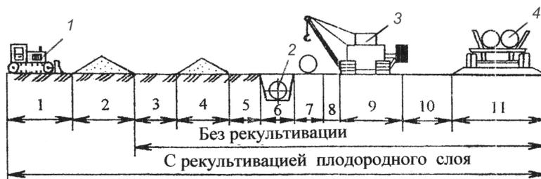
Рис. 5.1. Схема строительной полосы и размещения машин на период строительства:
