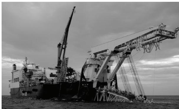
Рис. 1.44. Укладка труб на дно Балтийского моря при помощи трубоукладочного судна «Castoro»
