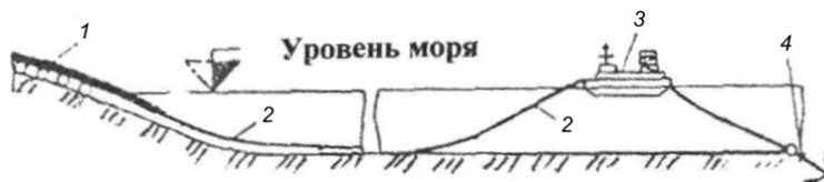
**Рис. 11.2. Схема протягивания трубопровода:**
