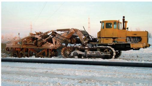
Рис. 7.5. Общий вид роторного траншейного экскаватора
