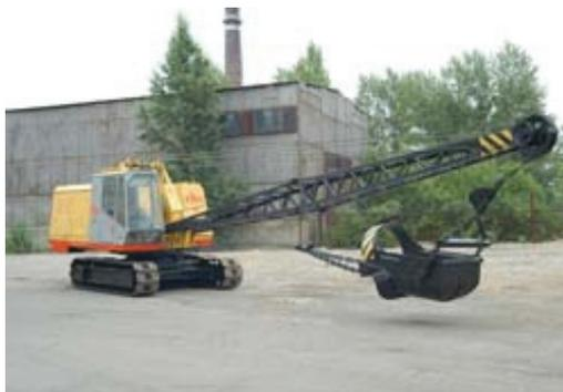
Рис. 7.30. Общий вид экскаватора ЭО-4112А-1 типа драглайн
