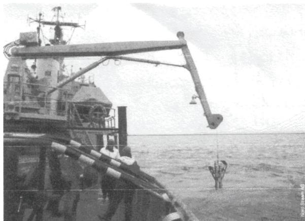
**Рис. 14.5. Отбор проб донных осадков Балтийского моря**
