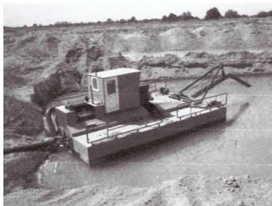
Рис. 10.7. Общий вид земснаряда ЭСК-1600/25
