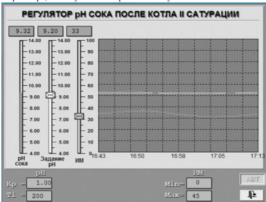
Рис. 4 Интерфейс регулятора поддержания рН после котла II сатурации
