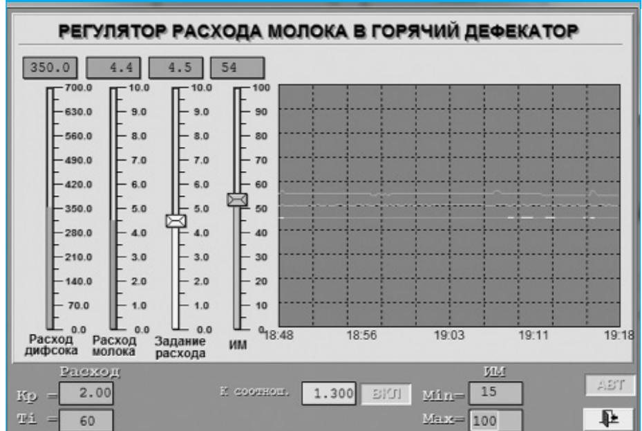
Рис. 3. Интерфейс регулятора расхода молока в горячий дефекатор
