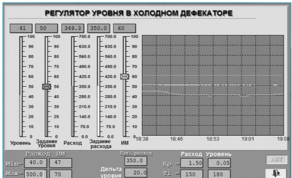
Рис. 2. Интерфейс регулятора уровня в холодном дефекаторе и расхода сока на горячий дефекатор
