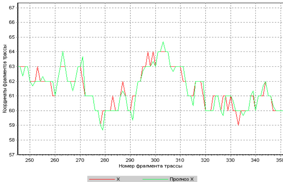
Рисунок 3 – Выполнение прогнозирования с помощью нейроподобной ПИ сети (увеличенный фрагмент)
