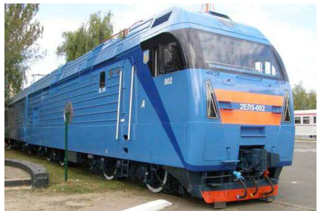
Рис. 2. Магістральний вантажний електровоз змінного струму 2EL15
