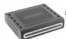
*Маршрутизатор* – устройство с несколькими физическими интерфейсами, возможно, различных сетевых технологий. Выполняет передачу пакетов данных между интерфейсами, имеющими MAC адреса.
